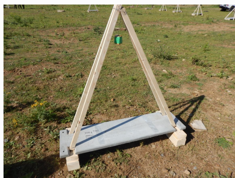
Kompozitová deska připravená na test odolnosti
