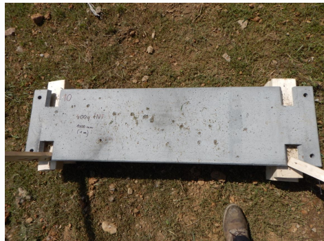
Kompozitová deska po testu 400 gr TNT
