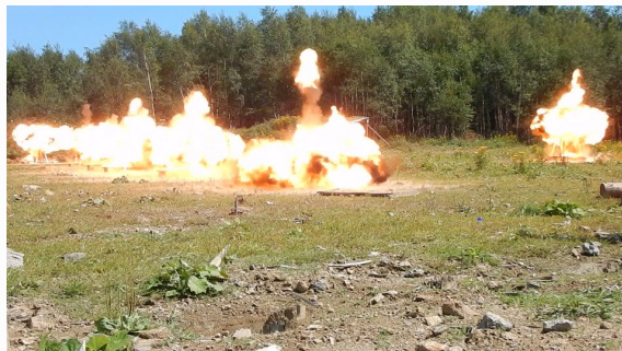
Zkoušky odolnosti na výbuch 1 kg TNT ve vzdálenosti 1 m
