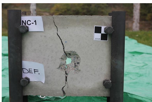
Výsledek destrukční zkoušky běžného betonu
