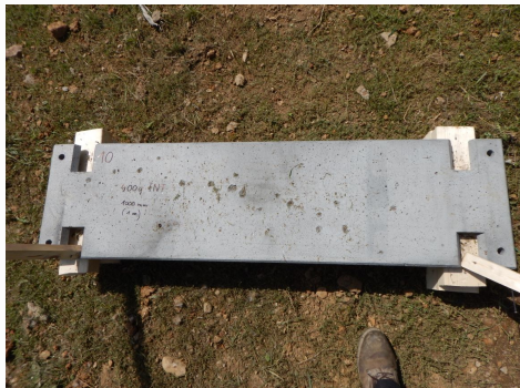
Kompozitová deska po testu 400 gr TNT
