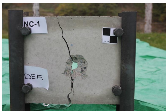
Výsledek destrukční zkoušky běžného betonu
