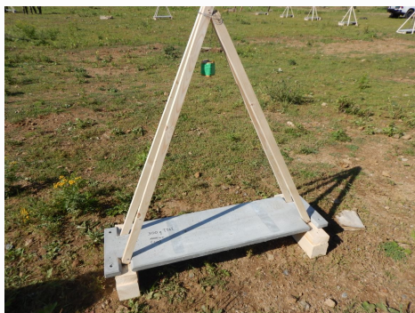
Kompozitová deska připravená na test odolnosti
