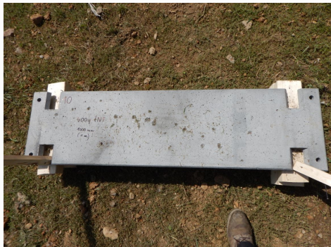
Kompozitová deska po testu 400 gr TNT
